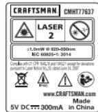
La herramienta CMHT77637 emite un rayo láser visible, como se muestra en la Figura A ①. El rayo láser emitido es un Láser Clase 2 en conformidad con la norma IEC 60825-1 y cumple las normas 21 CFR 1040.10 y 1040.11, excepto en las desviaciones en conformidad con lo establecido en Laser Notice No. 50, del 24 de junio de 2007.
