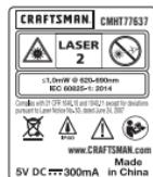
Les outils CMHT77637 émettent un faisceau laser visible, comme illustré par la figure A ①. Le faisceau laser émis est de classe 2 selon la norme IEC 60825-1 et il est conforme à la norme 21 CFR 1040.10 et 1040.11, excepté les écarts conformément à l'aviso sur le laser n°50 du 24 juin 2007.
